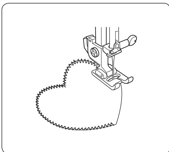
Приметайте или приклейте утюгом аппликацию на ткань с помощью “паутинки”. Прошейте вокруг аппликации так, чтобы в правом положении иглы стежки ложились за пределами края аппликации.
