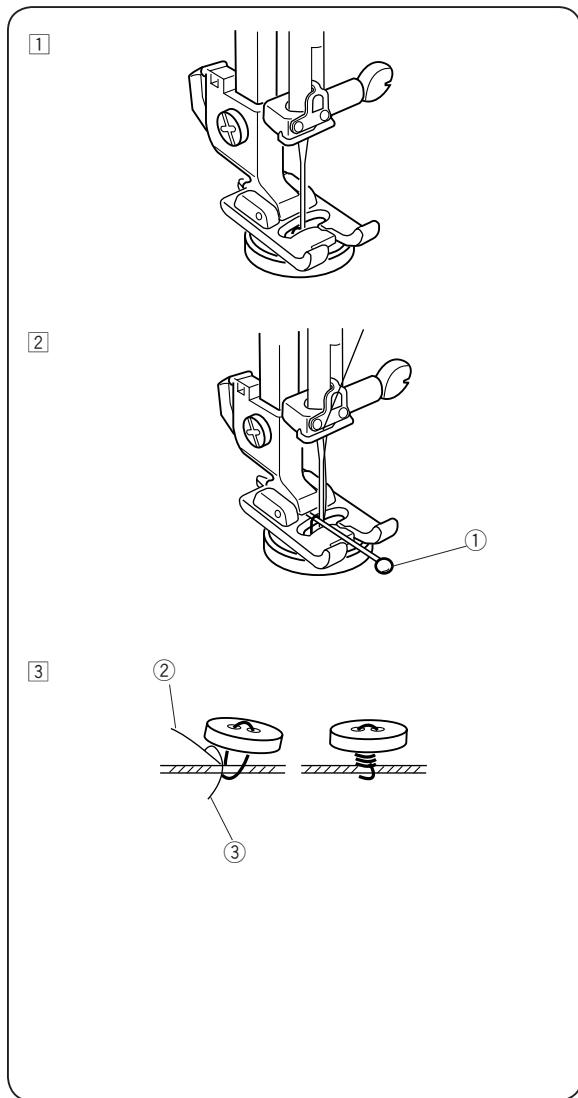
1 Удалите нить из иглы. Измените ширину зигзага так, чтобы игла сквозь прорезь на лапке попадала в отверстия пуговицы. Поверните маховое колесо и проверьте, входит ли игла в отверстия пуговицы. Опустите прижимную лапку, чтобы закрепить пуговицу на месте. Отверстия в пуговице должны совпадать с прорезью на лапке.
