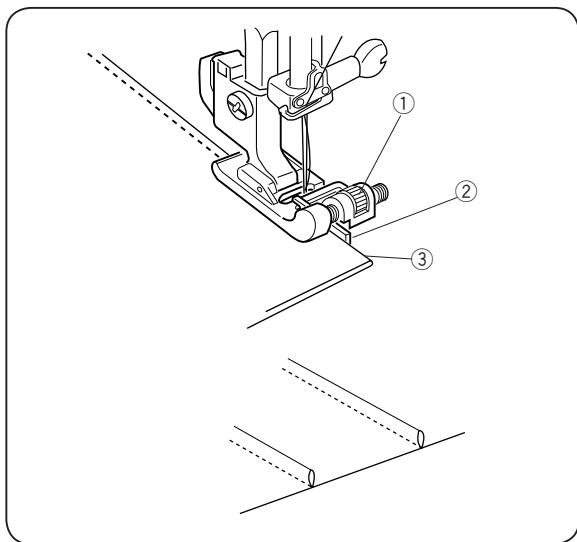
Сложите ткань лицевой стороной внутрь. Опустите иглу на расстоянии 1 – 2 мм от края. Опустите лапку. Поверните винт на лапке так, чтобы направитель лапки примыкал вплотную к сложенному краю. Шейте медленно, направляя сложенный край вдоль направителя на лапке. Разложите ткань и прогладьте складки.
