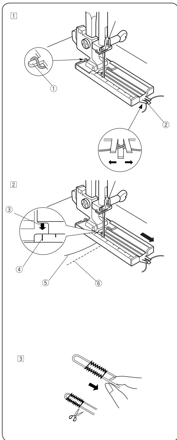
1 Поднимите лапку для автоматической петли, набросьте шнур на крючок сзади лапки. Переведите концы шнура вперед, заправив под лапку. Зацепите концы шнура в вилке впереди лапки, чтобы натянуть его.
