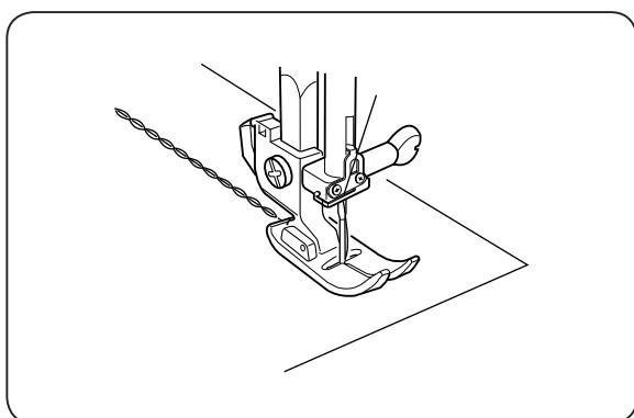
Эта строчка получается из двух стежков вперед и одного назад. Такой шов нелегко разорвать. Используйте его в области проймы и для втачивания рукавов.
