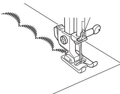
Определите необходимую плотность стежков на пробном лоскуте ткани.
